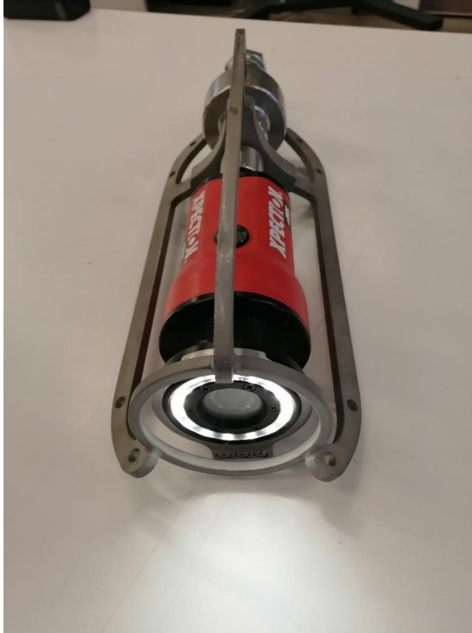
Kuva 4. Suutinkamera. Kuva SewCon Kuikka Oy.
