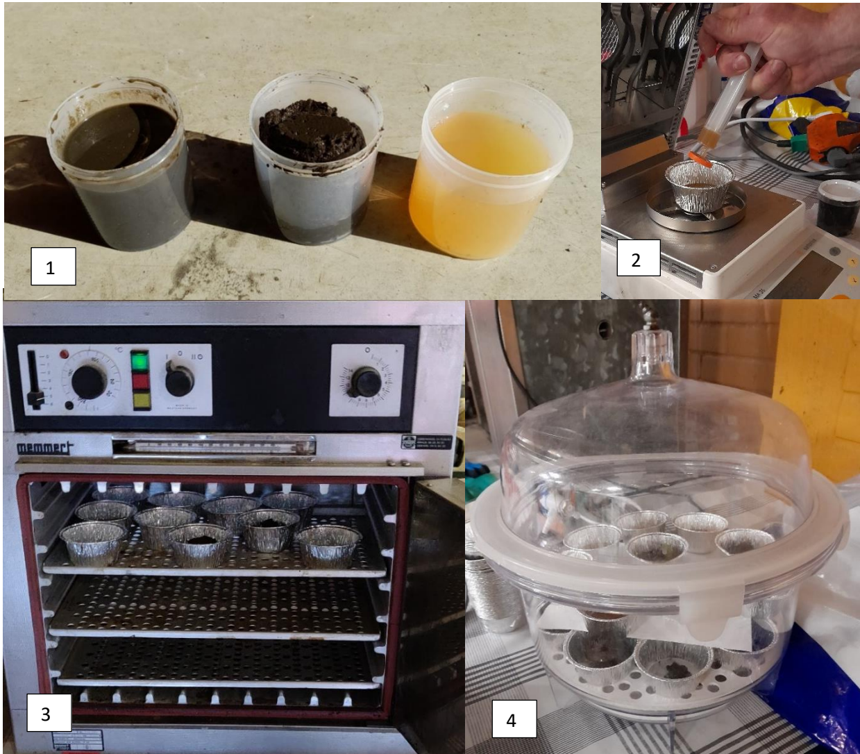
Kuva 6: 1. Näytteitä menossa kentällä tehtävään kiintoaineanalyysiin. 2. Rejektiväinänäytteestä suodatetaan liukenematon kiintoaine pois ruiskun päähän asetettavan filterin läpi. Suodatetusta näytteestä analysoitiin liuenneen kiintoaineen määrä. 3. Näytteitä kuivausuunissa, kuivaus kesti yön yli. 4. Näytteet jäähtymässä eksikaattiorissa punnitusta ja tulosten laskentaa varten.
