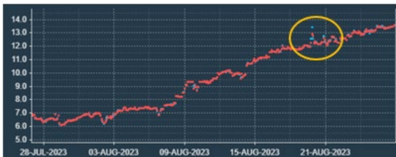
Kuva 15. Esimerkki väriluvun vaihtelusta verkostossa yhden kuukauden aikana. Ympyröity piikki johtuu runkojohdon sulkemisesta. Kuvassa Pipescan-mittarin dataa.
