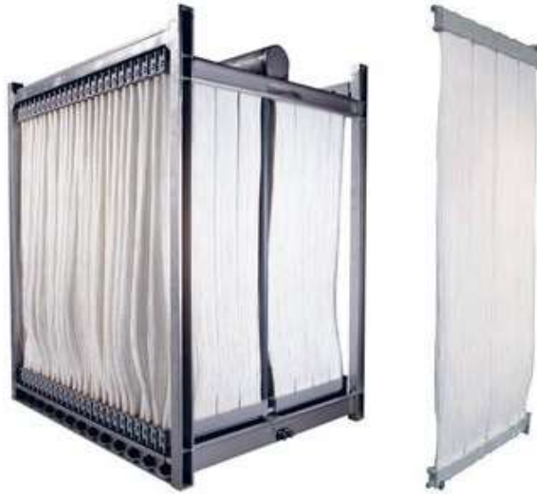
Kuva 7 Suez ZeeWeed 500 suodatuskalvon moduuli (oikealla) ja suurempi kasetti, joka sisältää muutaman kymmenen moduulia. Yhden moduulin korkeus on noin 1,5 m.
