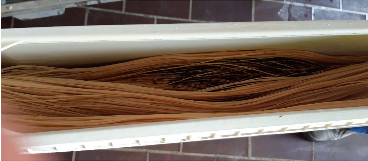
Kuva 16 Moduuleja poistettaessa tarkastettiin myös ontokuitujen kunto. Hieman päällimmäisiä kuituja siirtämällä havaittiin kuitunipun keskellä ferrisaostumia, jotka eivät poistuneet kemiallisilla pesuilla.
