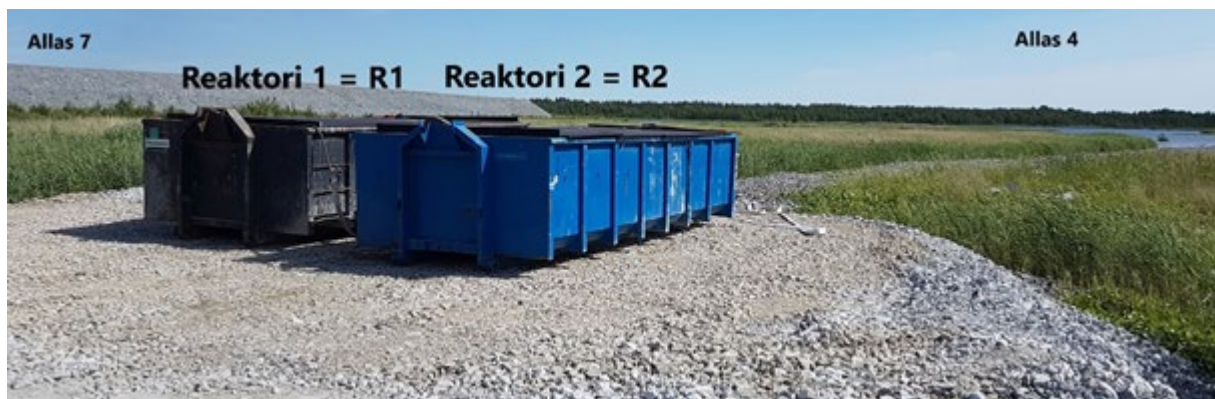
Kuva 55. Koivuhakkeella toteutetut denitrifioivat bioreaktorit Outokummun Kemin kaivoksella kesällä 2020. Kuva: Marjo Karnaatti.
