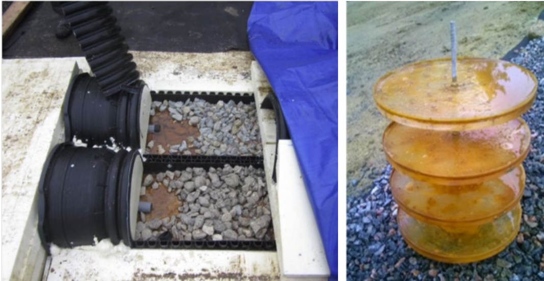
Kuva 9. Vasemmalla olevassa kuvassa on näkyvissä pH:n nostoyksiköiden pääty ja oikealla olevassa kuvassa hapetuslautaset. Kuvat: Heini Postila.
