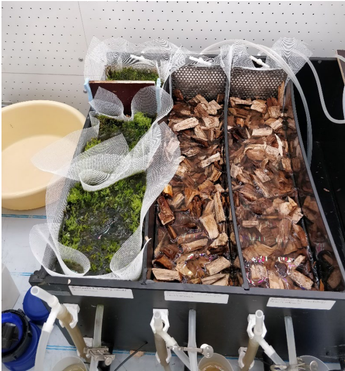
Kuva 56. Vesisammal- ja koivuhakereaktorin testaukset Kevitsan suotovesille typen ja metallien poiston tehostamiseksi keväällä 2020 Oulun yliopistolla. Kuva: Sepideh Kiani.
