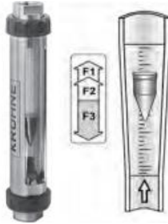
Kuva 15. Vesijohtoverkostosta poistuvan ilman mittaamiseen käytettävä rotametri. Ulosvirtaavan määrän kertoo koho, johon vaikuttaa poistuvan ilman noste F1 , kohon muodon vastus F2 sekä kohon paino F3 , jotka ovat tasapainossa F3 = F1 + F2 (Krohne 2017).
