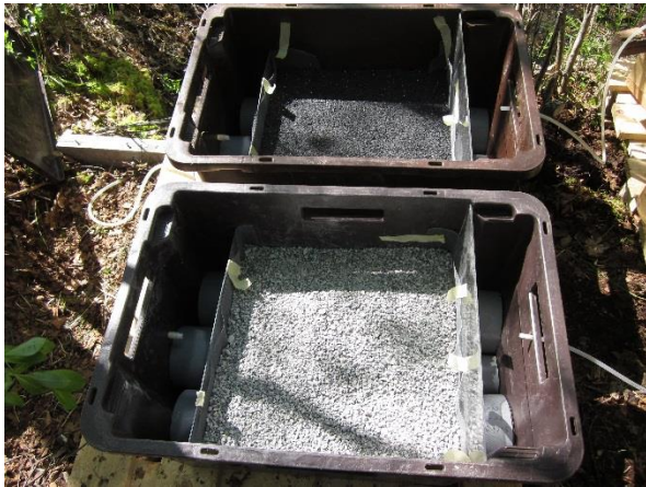
Kuva 1.5. ALOXRc kierrätetyllä mineraalituotteella (2-4 mm) ja OKTO JT-hiekalla (2-4 mm) täytetyt suodatinpilottilaatikot ennen vedensyötön aloitusta (Kuva: Heini Postila).
