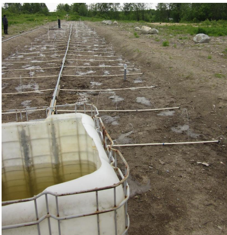
Kuva 2.4. Maanpäällä oleva 1 m 3 säiliö, ja vedenjakoputkisto kosteikolle. Vasemmalla näkyvän penkan päällä kulkee runkolinja, ja se tulee pituussuunnassa kosteikon keskelle, josta haarautuu molempia päitä kohden. (Kuva: Heini Postila)
