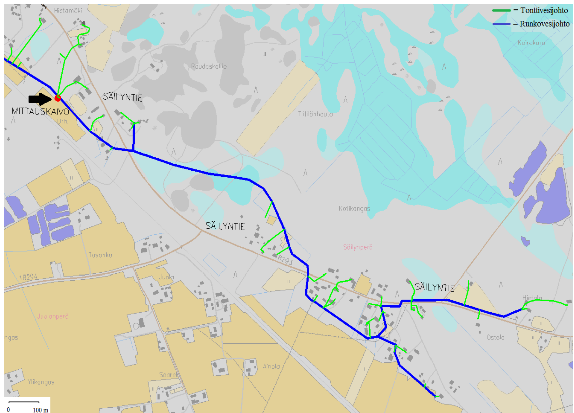
Kuva 2. Säilynpereän vedenmittausalueen vesijohtoverkosto.
