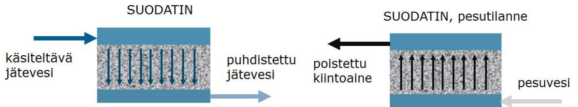
Kuva 1. Perinteinen hiekkasuodatin, käyttö- ja pesutilanne
