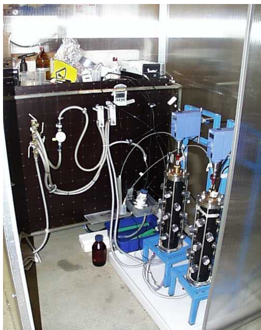
Kuva 2. Propella TM biofilmireaktoreita eristetyssä koetilassa.
