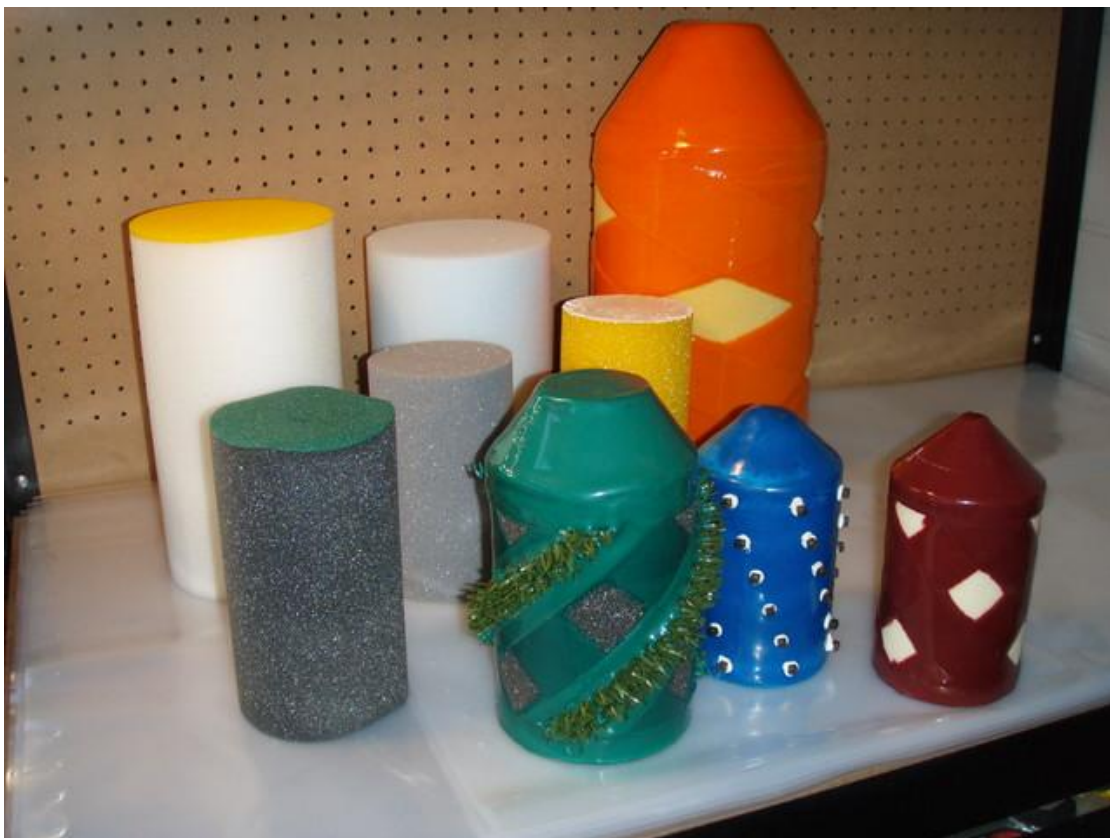
Kuva 22. Elementtipuhdistus (possutus) on tehokas vesijohtojen puhdistusmenetelmä. Kuvassa erilaisia puhdistuselementtejä.
