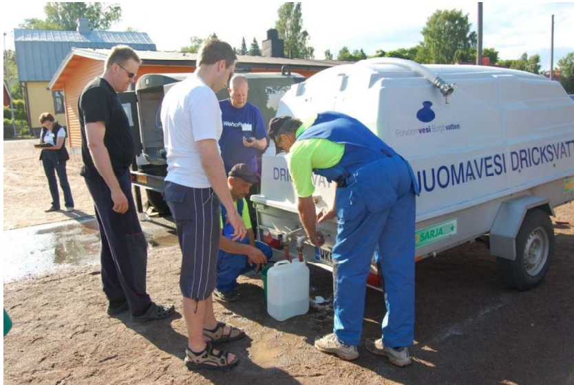
Bild 5. Fast vattenbehållare för 1 m 3 på släpvagn.
