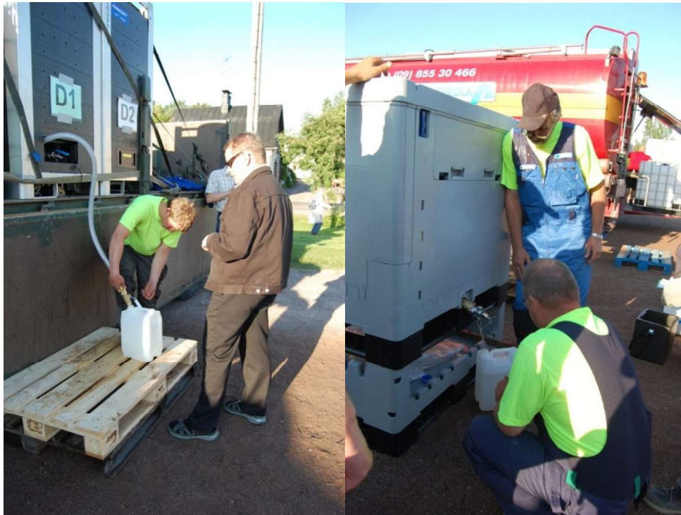
Bild 6. Hopfällbar behållare för 1 m 3 av typen Combo Aqua med en engångsvattenpåse och försvarsmaktens värmeisolerade behållare för 0,75 m 3 .
