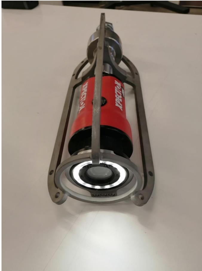
Kuva 4. Suutinkamera. Kuva SewCon Kuikka Oy.
