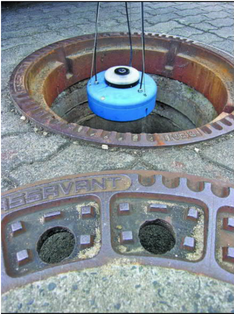
Kuva 4.2. Kaivojen tutkimiseen soveltuva laitteisto. https://www.mswmag.com/g/weftec-product-preview/2015/08/rapidview_ibak_north_america_panoramo_si
