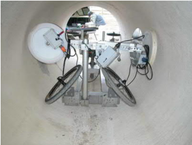
Kuva 3.25. Magneettisella menetelmällä toimiva tutkimusrobotti. https://pure-techltd.com/technology/purerobotics-pipeline-inspection-system/
